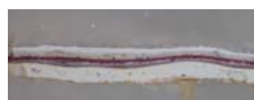
Przekrój boczny próbki pobranej z odkrywki nr 4 z widoczną niebieską i bordową warstwą.
